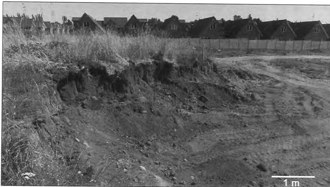
Fotografía 5-2: Punto de control 05. Vista hacia el suroeste. Se observan sedimentos arcillosos (potencia entre 1 y 1,5 m).
